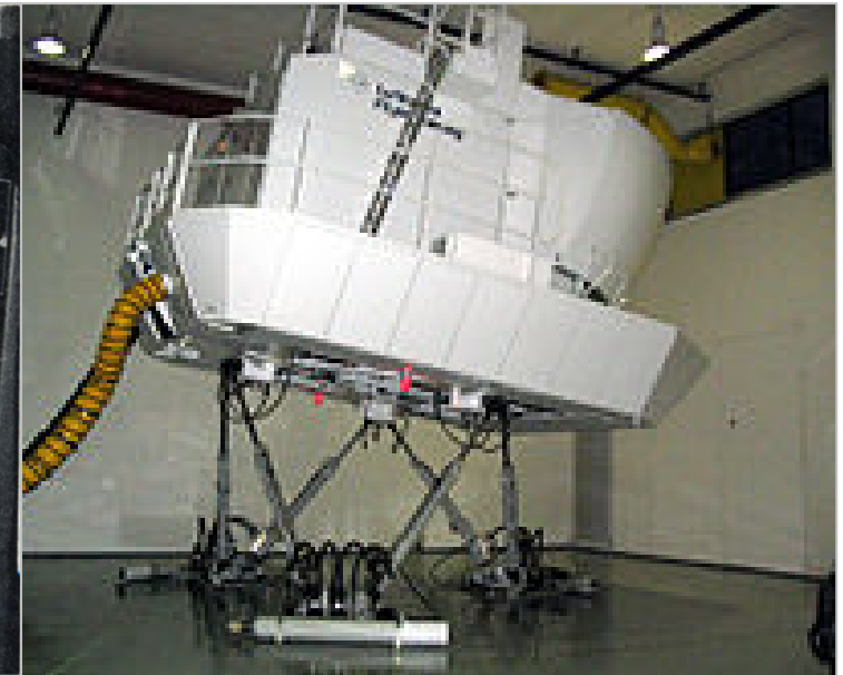
Flugsimulator mit hydraulischem Bewegungssystem, ab ca. 1980
